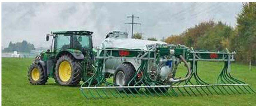
アンモニアの空中飛散を防ぐ糞尿散布機械
