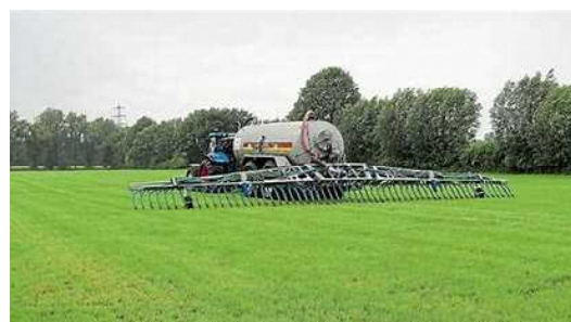
空中飛散を防ぐ糞尿散布機
